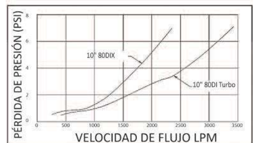
Modelo 80 DI TURBO de 10" en comparación con modelo 80DIX de 10" Tabla de comparación de pérdida de carga
